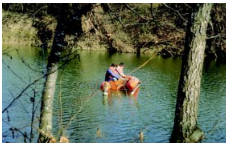
Photo 6.2 – Relevé bathymétrique au décimètre plombé sur un profil en travers du Vidourle dans sa partie endiguée.
