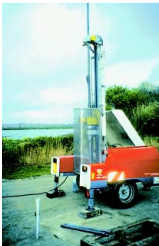
Photo 6.4 – Pénétrömètre dynamique PDG 1000 mis en station pour un sondage.
