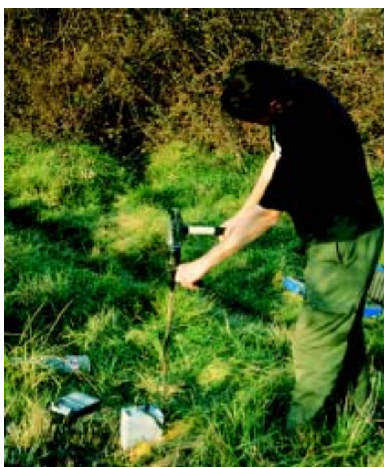
Photo 6.3 – Sondages au pénétromètre dynamique léger PANDA sur les digues du Vidourle.
