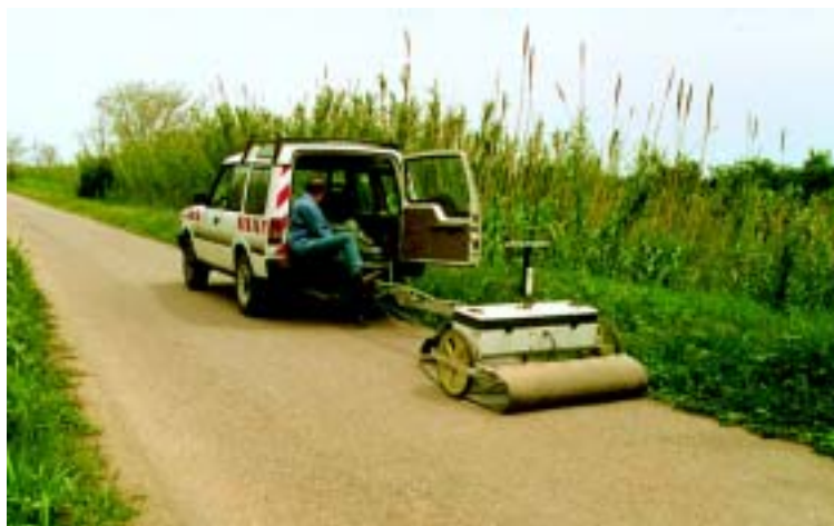
Photo 6.1 – Prospection géophysique par la méthode radio-magnétotellurique (RMT) en crête de la digue de l'Agly.
