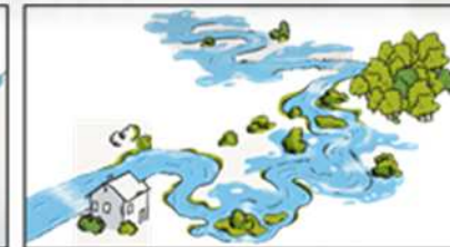
Rivière qui méandre* : ralentissement des écoulements
